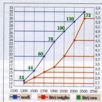
I consumi indicati nel grafico sono ricavati dalle curve di consumo all'elica fornite dai costruttori dei motori, ma il consumo reale in mare potrà discostarsi dai dati pubblicati in funzione del carico imbarcato, delle condizioni di uso dell'unità, della messa a punto e dello stato dei motori stessi, oltre che dalle caratteristiche delle eliche utilizzate.
